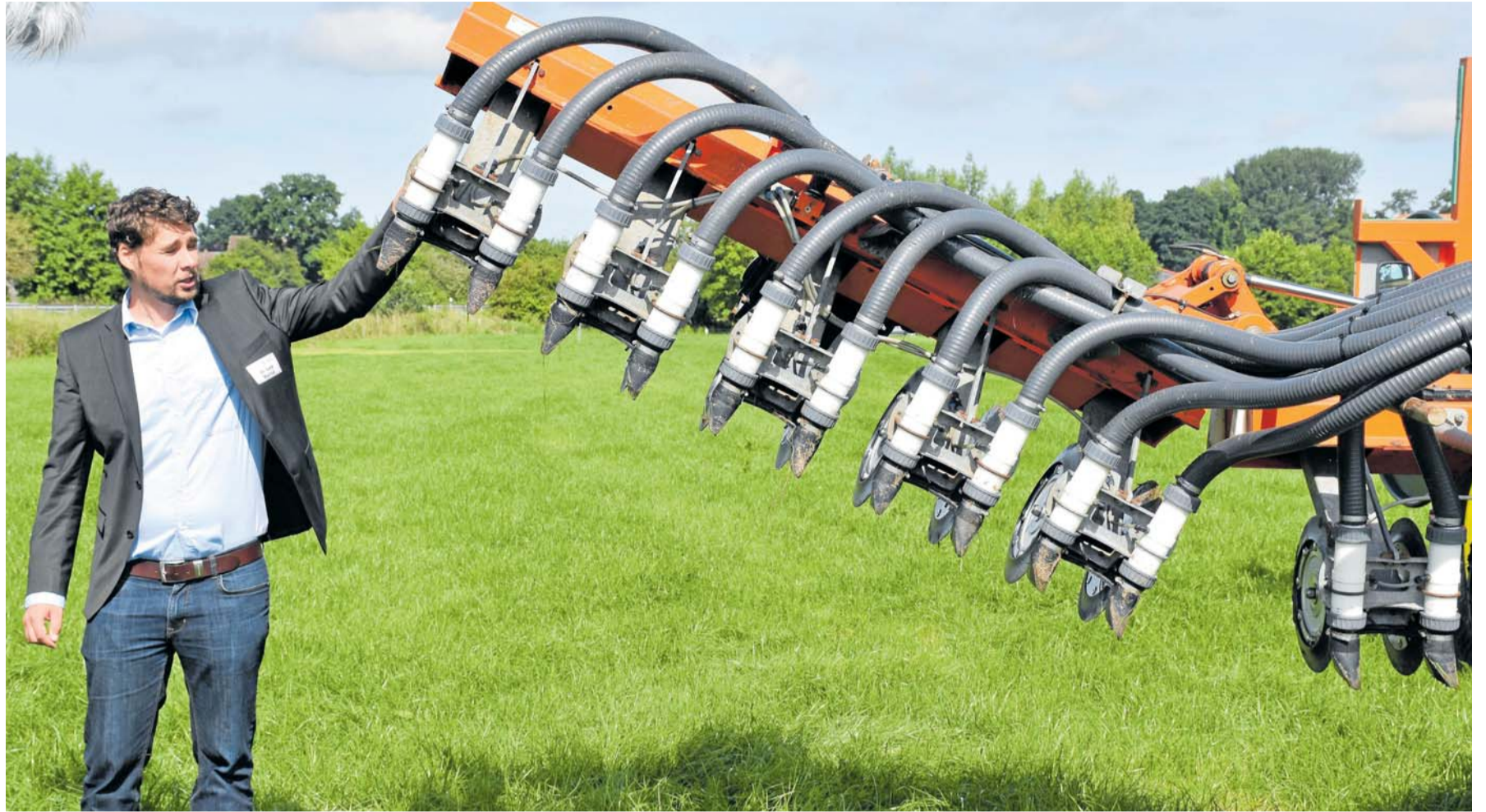
Lars Biernat von der Landwirtschaftskammer erklärt ein modernes Injektionsgerät, das Gülle direkt in den Wurzelbereich einer Wiese ablagert.
